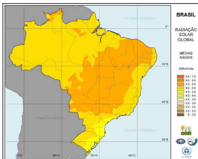
Figura 8 : distribuição da irradiação global direta nos diferentes estados do Brasil. Fonte: CPTEC/INPE/SWERA (2010).
