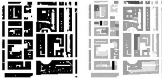
Figura 36: mapa do solo urbano mostrando áreas construídas (figura) e não-construídas (fundo); e MDE – modelo digital de elevação – para uma cena urbana selecionada na cidade de Londres. Fonte: Ratti e Richens, (1999).
