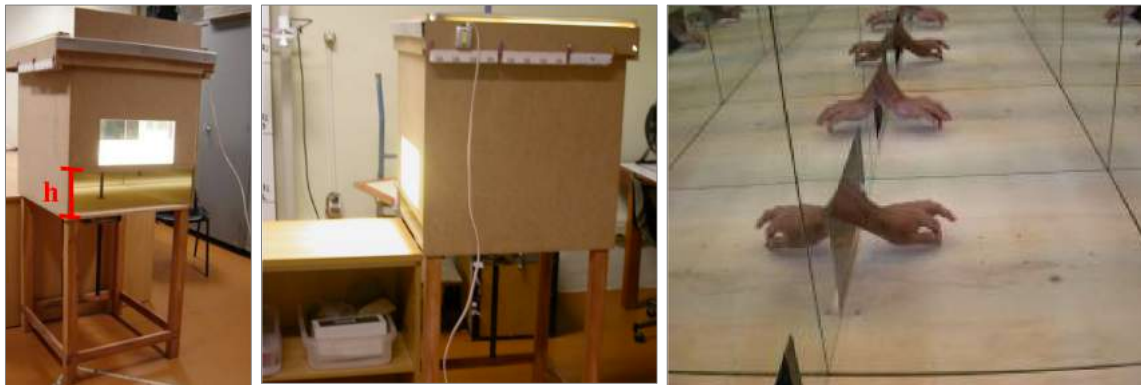
Figura 48: exemplo de céu artificial retilíneo. Fonte: Luz, Ferreira et al. (2008).
